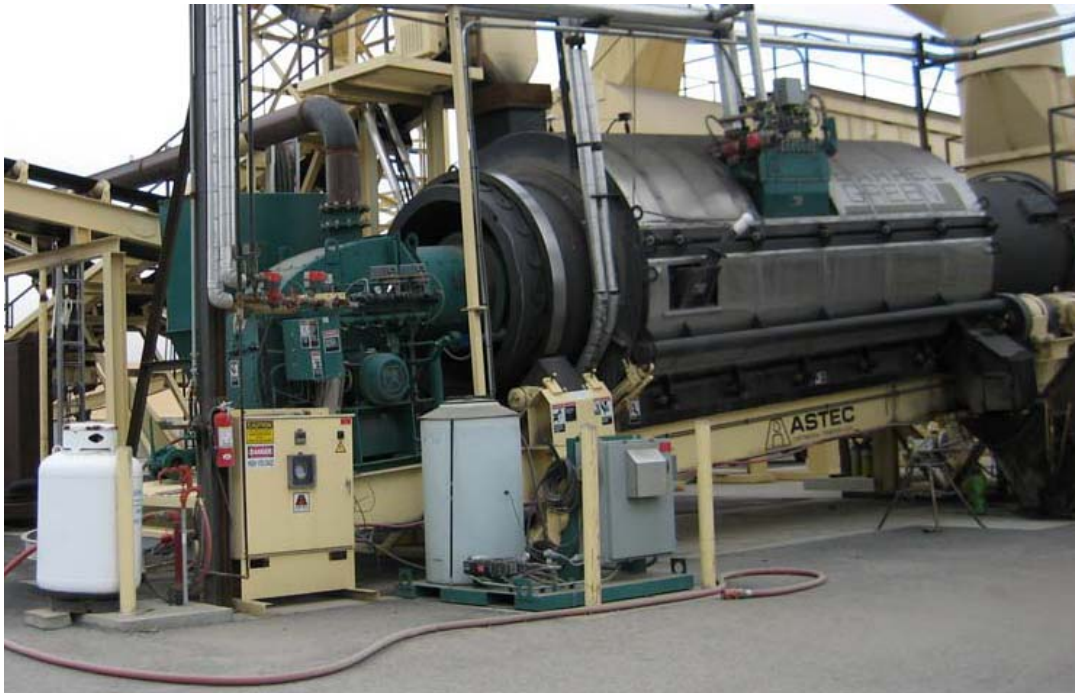
Рис 12: Вращающийся барабан нагрева асфальта с горелкой использующей пылеугольное топливо.
