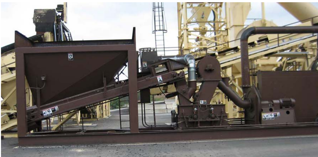
Рис 13 : Установка локального приготовления пылеугольного топлива, включая (слева - направо) сырьевой бункер кускового угля, питатель, молотковую мельницу, воздушный сепаратор, вентилятор подачи угольной пыли к горелке.
