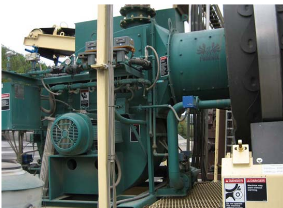
Рис 11 : Пылеугольная горелка в блоке с дутьевым вентилятором для вращающегося барабана производства асфальта
